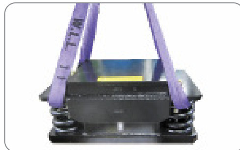
Abb. 4: Hebevorrichtung für Federelement mit Schlinge
