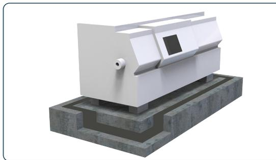
Esta medida es recomendable, por ejemplo si las vibraciones procedentes de los cimientos pueden perjudicar el funcionamiento de una máquina sensible. Se colocan apoyos elastoméricos como capa intermedia con respuesta elástica suave de superficie completa.
