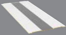
Apoyo para techos Cigular EcoLine 2.0 de Calenberg, elemento elástico de EPDM perfilado, altamente resistente al envejecimiento; resistente al ozono hasta 200 pphm, con recubrimiento Ciflamon, grosor 10 mm, anchura total 300 mm, homologación N° Z-16.32-479. Se cumple el requisito F90 de acuerdo con la evaluación de protección contra incendios n° 3799/7357 -AR-, siempre que, tras el montaje, ambos lados del recubrimiento presenten una anchura mínima de 30 mm.
